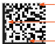
Exemplo: defeitos no Padrão Localização L e no Relógio de Sincronismo:
